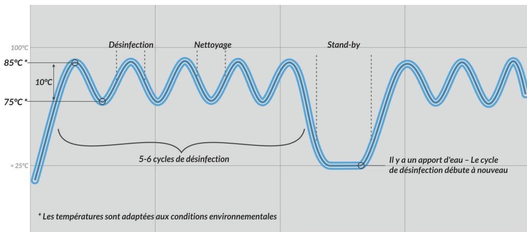
La thermo-désinfection avec le MoveoSiphon remplit au minimum les conditions du processus technique de la pasteurisation sous la forme d'un échauffement élevé (10 à 15 secondes à 85° C). A cette occasion, il y a un réchauffement à la température théorique pré-réglée (85° C) et un refroidissement lent pendant le nettoyage par vibrations qui suit.
